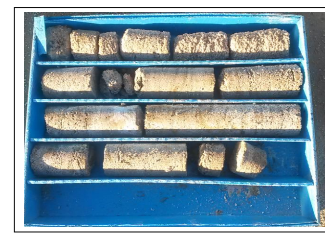
Foto 12: Sondeig S-4 de 6.0-10.0 m Dificultat de recuperació dels darrers metres de mostra.
